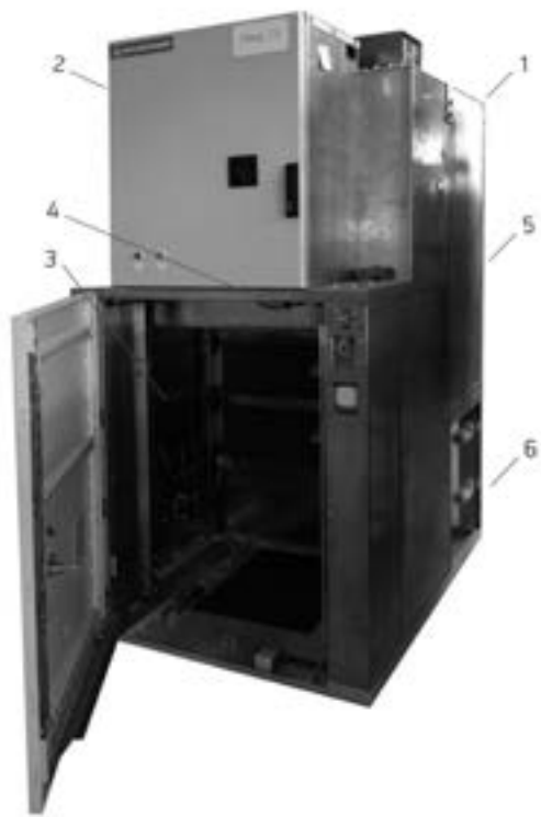
Рис. 3.17 Шкаф КРУ серии К-128 на номинальные токи 2000-4000 А 1 – корпус шкафа; 2 – релейный шкаф; 3 – отсек выкатного элемента; 4 – привод ЗР; 5 – линейный отсек; 6 – отсек сборных шин
