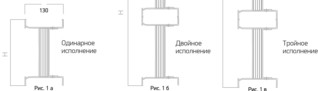
Рис. 1 Варианты исполнения шинопровода в зависимости от номинального тока: а) с одним пакетом; б) с двумя пакетами; в) с тремя пакетами
