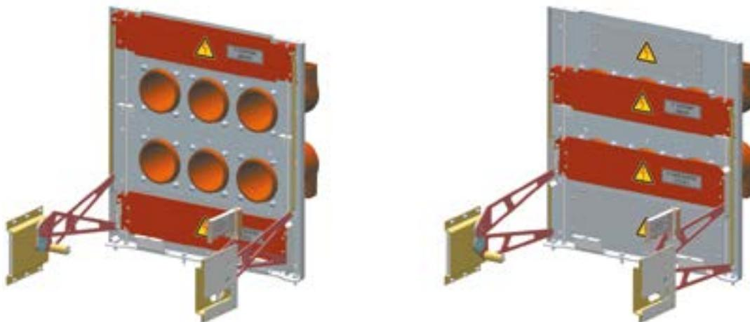
Рис. 1.9 Шторочный механизм КРУ серии К-132
