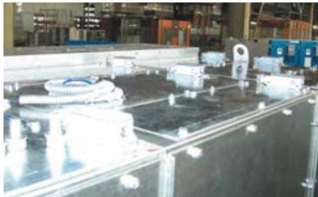
Рис. 2.2 Разгрузочные клапаны и концевые выключатели высоковольтных отсеков
